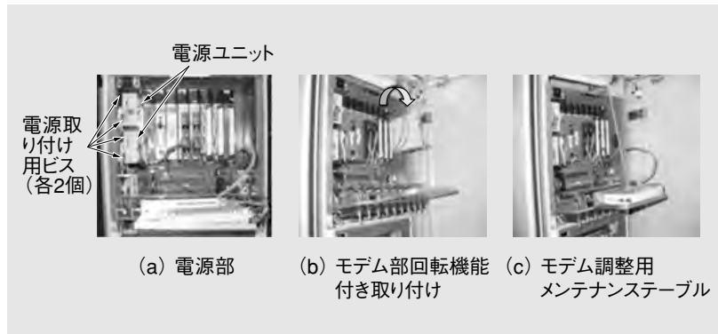
第3図 フロントアクセスによる保守性の向上 フロントアクセス方式にしたことで保守性が向上した。
