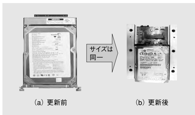
第12図 SCSIディスク装置 メンテナンス用SCSIディスク装置の代替製品を示す。
