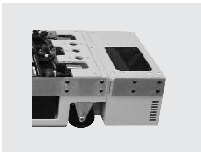
第8図 拡張ボックス 自動充電・無線LANなどのオプションユニットを収納した拡張ボックスをU-CART後部に取り付ける。
