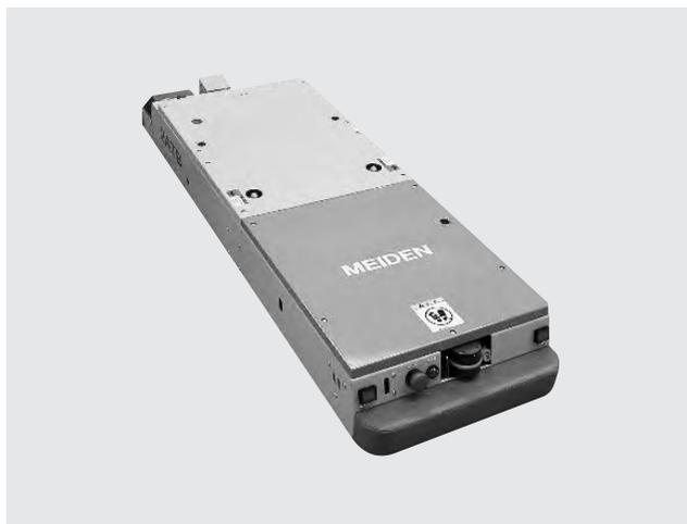
第19図 電気自動車用インバータ部品工程間無人搬送車
