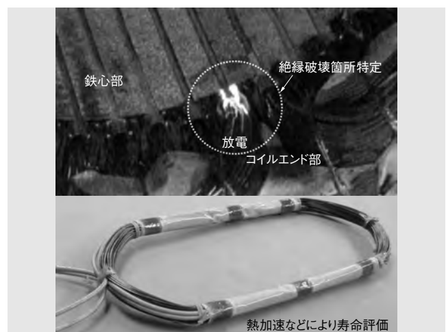
第14図 実機絶縁破壊試験（上）とモデルコイル例（下）
