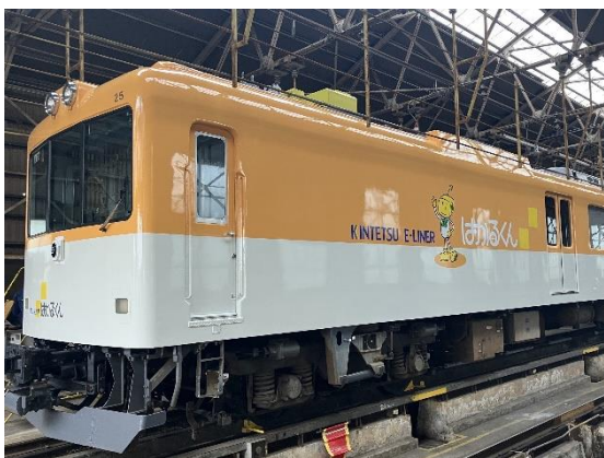
「カテナリーアイ」が搭載された 電気検測車「はかるくん」
