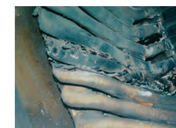
かご形誘導電動機の固定子巻線地絡
