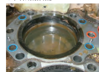
バックギン劣化による冷却水の混入
