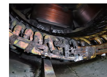
常用エンジン発電機固定子巻線の焼損
