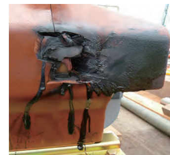
VTの経年劣化による焼損
