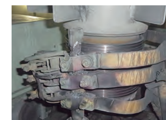
巻線形誘導電動機集電装置部の焼損
