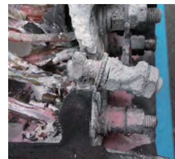
モールド変圧器タップ切替部振動による緩みで焼損
