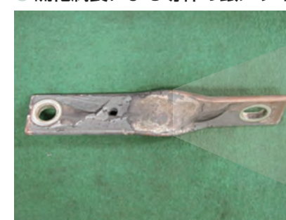
銀メッキが剥離した導体（コンタクト側）
