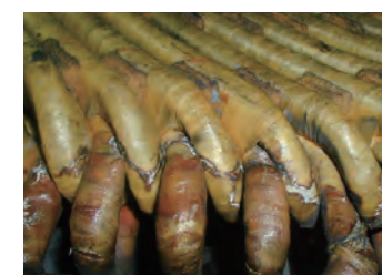
かご形誘導電動機固定子巻線のトラッキング劣化による障害例です。
