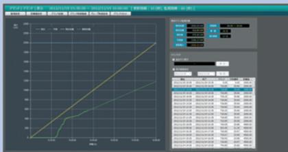
デマンド推移グラフ、現在・予測・調整電力、デマンドなどを表示します。3段階の警報レベル、季節別、時間帯別の電力契約にも対応しています。
