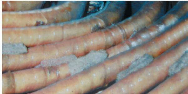
電動機ステータコイル絶縁破壊
