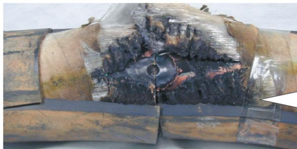
絶縁破壊した高圧ケーブル
