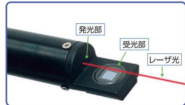
LTB-1000のセンサ部です。レーザ光束に対し90度の角度に受光部が配置されています。発光部・受光部ともに表面は平滑で、汚れの拭取りが簡単です。
