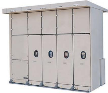
明電産業用SISは、従来空気絶縁に頼っていた構成機器の高圧充電部のすべてを、絶縁性能の優れたエポキシ樹脂モールドで被って縮小化し、その外表面は金属メタリコンを施して接地層を形成した“固体絶縁開閉装置”に、多機能形デジタル保護継電器を搭載した高性能縮小配電装置です。変電所の小形化と安全性の向上を図ると同時に、装置の信頼性向上、保守の省力化などによる総合経済性(ライフサイクルコスト)の向上も可能とした配電装置です。昭和46年の1号機納入以降、計18,000面以上の実績を有し、安定した電力供給が求められる電力会社、半導体製造工場、インテリジェントビルなどで活躍しています。
