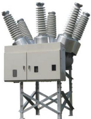
対地絶縁にSF<sub>6</sub>ガス(温室効果ガス)を使用せず、環境配慮5項目(3R・LS)を考慮した環境低負荷型のタンク形真空遮断器です。
