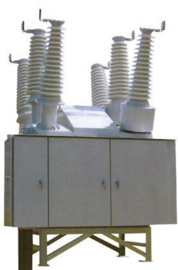
C-GISの技術をベースとし、真空遮断器・断路器・接地開閉器・避雷器・変流器を一体に構成し、合理的に複合化しました。C-GISの性能と信頼性を有し、外形はタンク形遮断器と同等のコンパクト設計です。オープン変電所の新設・更新並びに移動変電設備として最適です。
