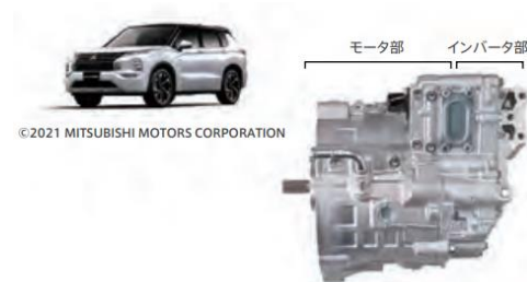
三菱自動車工業様 アウトランダーPHEV搭載リアユニット
